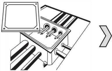
La cajas de pase para aplicaciones residenciales y comerciales (pisos y veredas) se emplean normalmente en la forma empotrada y fijando la tapa con el lado antideslizante hacia afuera.
